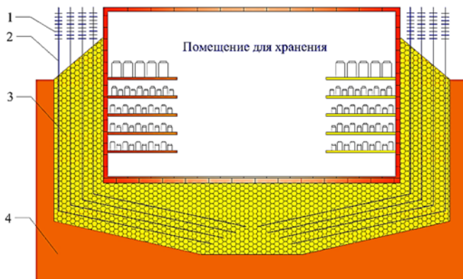
Рис. 1. Схема использования тепловых труб при аккумуляции холода:
