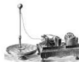
без проводов. Этот день стал днём рождения радио. Он сконструировал прибор, реагирующий на электромагнитные волны. Сначала приёмник мог «чувствовать» только атмосферные электрические разряды молнии. А затем, научился принимать и записывать на ленту телеграммы, переданные по радио. Лишь позже по радио смогли передавать голос и музыку.
