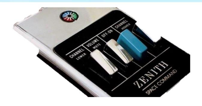
Спустя всего год (уже *в 1956 году*) американский изобретатель *Роберт Адлер* изобрел пульт дистанционного управления Zenith Space Commander. Это было механическое устройство. При нажатии на ту или иную кнопку на пульте (выбор канала или регулировка громкости), происходил удар о соответствующую пластину внутри пульта, которая издавала слышимый звук определенной частоты. Специальная электрическая схема внутри телевизора распознавала этот звук и выполняла соответствующие действия.
