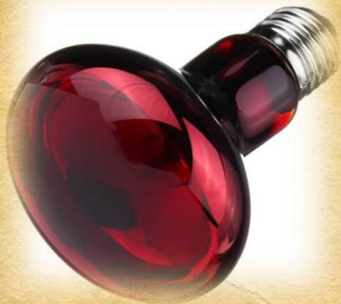
Инфракрасные лампы делаются на основе ламп накаливания. Однако, инфракрасные лампы работают в режиме недонакала нити. Ощущается только тепло и видимая небольшая часть светового спектра.
