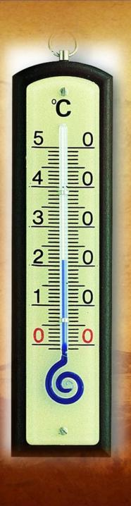
Термометр- прибор для измерения температуры воздуха и почвы
